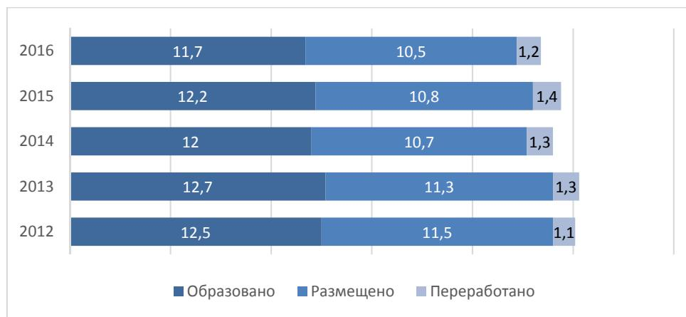
Количество переработанного шлама напрямую зависит от реализации мероприятий по строительству шламовых карт. В 2016 году объем образования шлама глиноземного производства сократился и составил 11,7 млн тонн, уменьшился до 1,2 млн тонн и объем переработки шлама.
