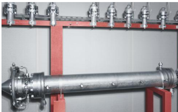
Рис. 2. Реактор гомогенного окисления.
