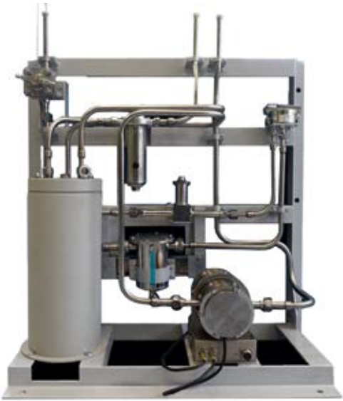
Рис. 2. Блоки детектирования БДГБ-50Р, БДГБ-51Р и вспомогательные блоки (каплеотбойник, расходомер, кран распределительный), размещенные на специальном стенде
